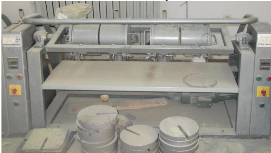
Photo IV.14. Appareil de l'essai Micro Deval.
