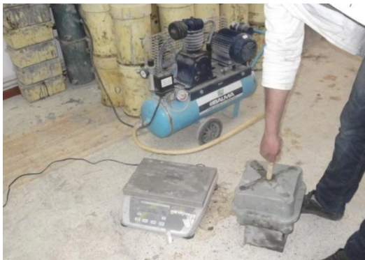
Photo V.4. Démoulage des éprouvettes.
