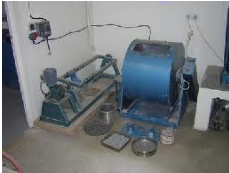
Photo IV.13. Appareil de l'essai Los Angeles.
