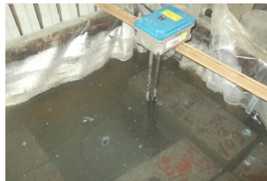
Photo V.5. Maturation des éprouvettes dans le bac thermostat.
