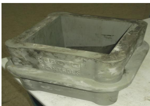
Photo V.1. Moule cubique 15*15*15 cm.
