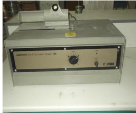
Photo IV.6. Matériels utilisés pour Équivalent de sable.
