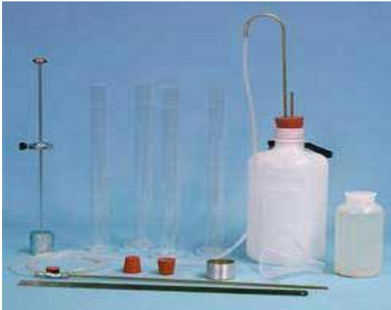
Photo IV.6. Matériels utilisés pour Équivalent de sable.
