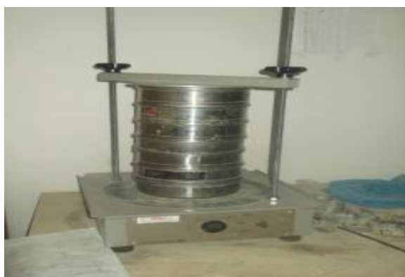
Photo IV.4. Un vibro-tamis électrique.
